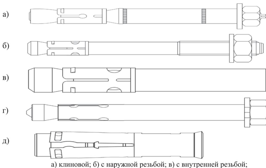
Рисунок А.6 – Анкеры с контролируемым моментом затяжки
